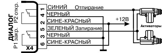
Рис. 6. Схема подключения дверных замков с инверсией полярности
